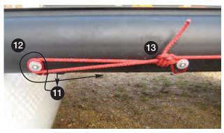
NOTE; THE TRAMPOLINE LACING WILL NEED TO BE RETIGHTENED FROM TIME TO TIME TO ENSURE THAT THE TRAMPOLINE REMAINS TAUT.
